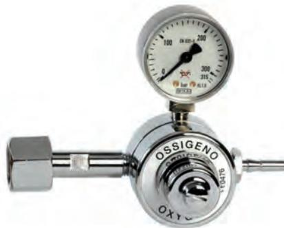
Riduttore bombola a membrana per ossigeno, con manometri (alta pressione e bassa pressione), connessione a dado per l'ingresso e uscita a portagomma.
